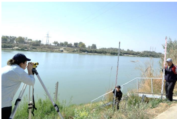
Рис. 5. Нивелирование на берегу реки Сырдарьи
